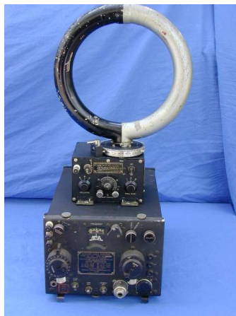
Abbildung 4: Bendix RA1-B/DU-1 von 1941 (Quelle: Radiosammlung Antonio Fucci, Italien)
