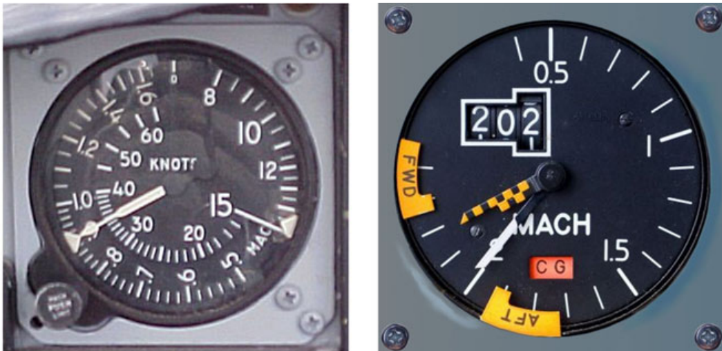
Abbildung 54: links F104 KIAS/Mach-Anzeige, rechts Machinstrument der Concorde (Quellen: links f-16.net, Ziffernblatt rechts BNPS.co.uk)
