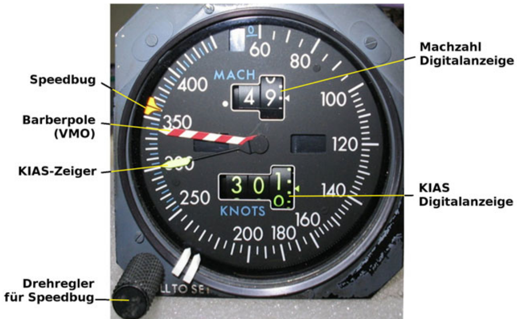
Abbildung 53: KIAS/Machzahl-Kombiinstrument (Quelle Basisfoto: tzywen.com)
