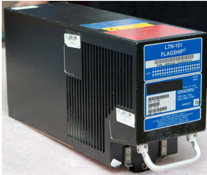
Abbildung 64: Moderne ADIRU, Litton LTN 101 (Quelle: Flightglobal.com)
