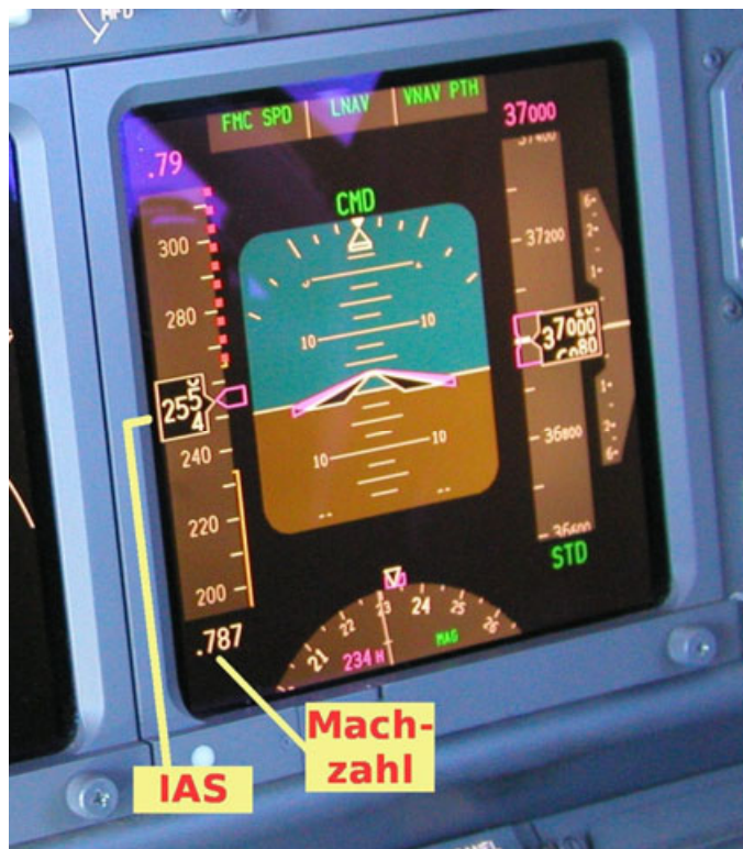
Abbildung 56: Vertikale IAS-Anzeige, am unteren Ende Machzahl, am oberen Ende Machzahl-Sollwert (Basisfoto: austrianaviationart.org)
